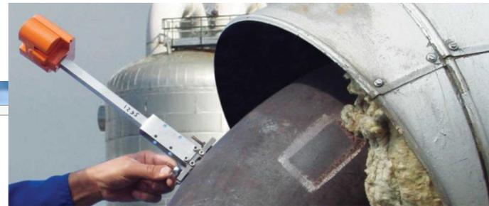
**Ultraschallmessung mit Funksensoren**
